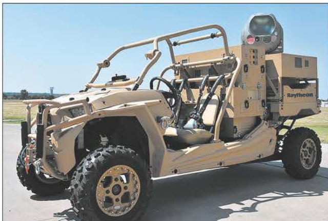
Лазерный боевой комплекс HELWS на базе легкого автомобиля повышенной проходимости MRZR
