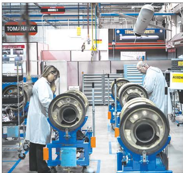
Сборка крылатых ракет морского базирования «Томахок» на заводе в г. Тусон (штат Аризона)
