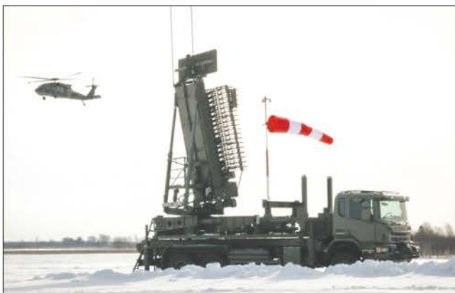
В марте 2018 года были завершены приемочные испытания первой полученной из США мобильной многофункциональной РЛС контроля воздушного пространства TPS-77 MRR (авиабаза Лиелварде, Латвия)
