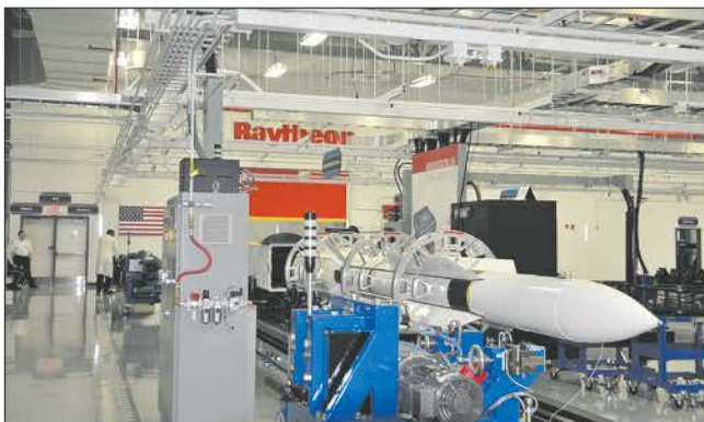
Цех окончательной сборки противоракет RIM-161 «Стандарт-3» в г. Хантсвилл
