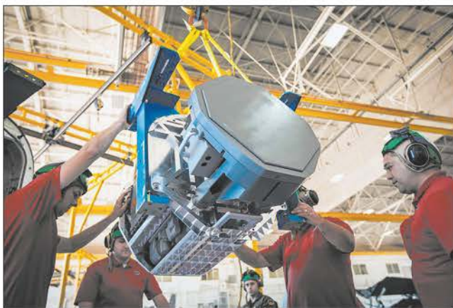
Отгрузка заказчику готовой многофункциональной РЛС с АФАР AN/APG-79
