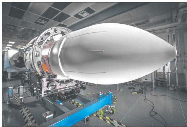
Сборка контейнерной системы РЭБ AN/ALQ-249 на заводе в г. Эль-Сегундо (штат Калифорния)
