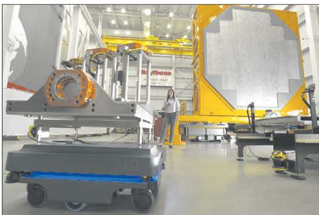
Монтаж станции AN/SPY-6(v) в центре по разработке РЛС
